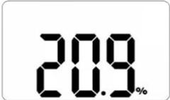
Cuando se activa, en el modo de medición, la concentración de gas o la duración de la batería restante (Opción) aparece en la pantalla. - La concentración de oxígeno se muestra en porcentaje por volumen (% Vol) y la concentración tóxica se muestra en partes por millón. (PPM)
