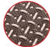
requerido para completar pruebas de abrasión tradicionales, es necesario utilizar el test método EN 388 para guantes de trabajo, prueba con papel de lija muy agresivo a la presión máxima de 12kp. Los resultados mostraron una resistencia de HYPERTEXT 6 veces más alto que Cordura 1000, comúnmente utilizado para productos de alto rendimiento.
