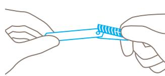
Schieber anheben, Klinge entnehmen, wechseln und wieder **genau auf die Nocke legen**. Linkshänder drehen die Klinge um 180°. Die zwei Magnete halten die Klinge zusätzlich fest.
