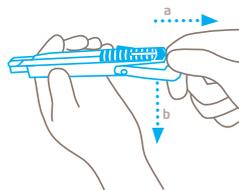
Klingenswechselknopf in Pfeilrichtung (a) nach hinten ziehen, Griffende nach unten klappen (b) und Klinge mithilfe des Schiebers **aus dem Griff bewegen**.
