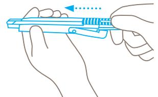
Zuletzt schieben Sie das Innenteil samt Klinge **in den Griff zurück** und klappen Sie das Griffende nach oben. Die Klinge testweise auslösen und wieder zurückschnellen lassen.
