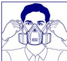
6. Ziehen Sie die unteren Bänder an den hinteren Befestigungen fest (die Spannung der Bänder kann durch Herausdrücken der Laschen gelockert werden).
