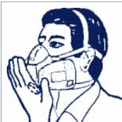
4. Überprüfen Sie den Dichtsitz durch Über- oder Unterdruck, wobei die Überdruckmethode zu bevorzugen ist.
