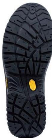
Semelle avec embout d'usure. Semelle d'usure en caoutchouc Vibram® résistante à 300° C par contact (HRO), aux acides et huiles. Dessin de la semelle d'usure autonettoyante, avec Standard Antislip SRC.
