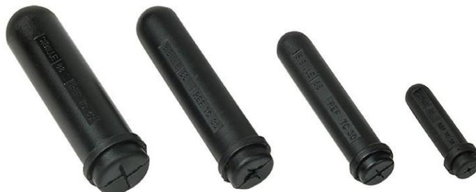
Utilisé pour le réseau aérien, souterrain et installations intérieures. Il est destiné à isoler l'extrémité dénudée d'un conducteur isolé (cette longueur doit être au plus égale à celle du capuchon diminuée de 10 mm) pendant la durée des travaux.
