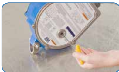
B. Desserrez l'extrémité du câble d'origine et retirez l'ensemble de la ligne de vie.
