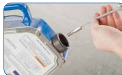
C. Insérez le nouvel ensemble de la ligne de vie et fixez-le en place. Retenez la ligne de vie, desserrez le verrou
