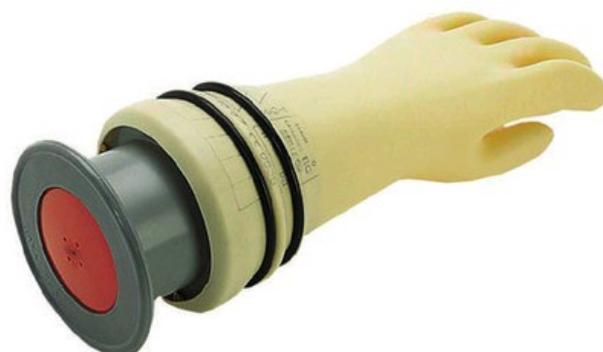
Le testeur permet de contrôler la parfaite étanchéité.
