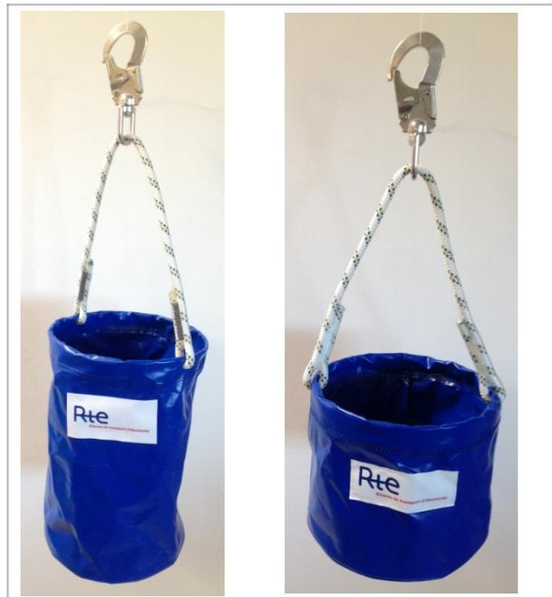
Sac en toile PVC diamètre 28cm, haute résistance avec double couture, pour le transport d'équipement lors de travaux en hauteur. Intégrant une corde statique diamètre 12mm cousue, un connecteur mobile à émerillon et double languets ouverture 25mm. Fond intérieur protégé et renforcé, intégrant un œillet pour l'évacuation de l'eau.
