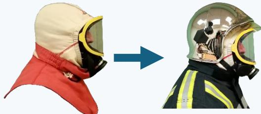
**Feux de structures** : voies aériennes totalement dégagées, masque tissu rouge baissé → filtration active par ARI et filtration passive par le complexe filtrant Nanoflex sur la tête et par le complexe maille + tissu sur les épaules.
