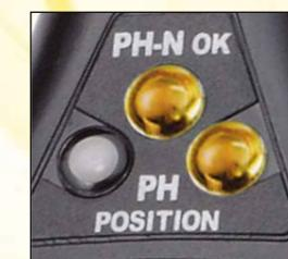
Dans ce cas, le câblage de la prise est correct : le néon central et l'un des deux néons d'extrémité (position de la phase) s'allument.
