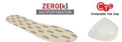
Embout en matière plastique, ultraléger résistant au choc de plus de 200J, élastique. Athermique. Non décelable au détecteur de métal. Semelle intercalaire tissée. Résistant à plus de 1100 N à perforation zéro.
