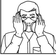
Contrôle de l'étanchéité au visage par pression négative: placer les paumes de main sur les filtres anti-gaz et inspirer doucement. Si le masque est étanche, la pièce faciale va subir une légère contraction aspirant le visage. Ajuster le masque et réitérer la procédure si nécessaire.
