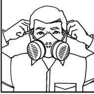
Régler la tension des brides. Contrôler que l'étanchéité entre le visage et le masque est bien réalisée avant de rentrer dans la zone d'exposition.
