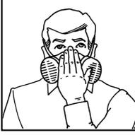
Contrôle de l'étanchéité au visage par pression positive: placer la paume de la main sur la soupape expiratoire et expirer doucement. Si le masque assure une bonne étanchéité, aucun filet d'air ne doit s'échapper entre le masque et le visage. Ajuster le masque et répéter l'opération si nécessaire.
