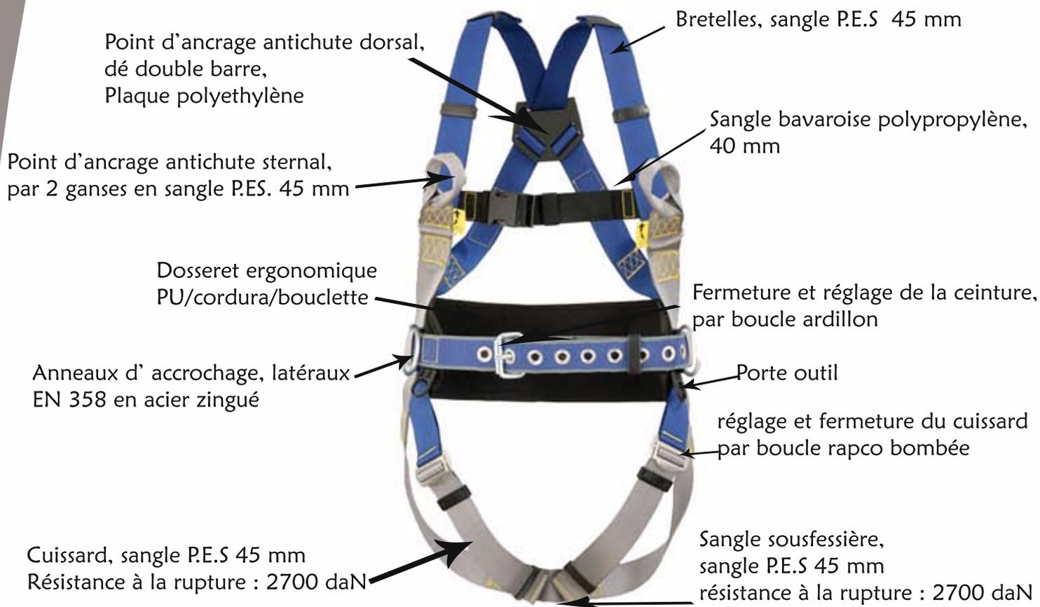
**Produit et utilisation :** Harnais muni d'un point d'ancrage dorsal et de points sternaux conformes EN 361 et d'anneaux d'accroche latéraux conformes EN 358. Electricité industrielle, charpente métallique. Ce harnais doit être utilisé connecté à un système antichute conforme EN 353/1, EN 353/2, EN 355, EN 360 par un mousqueton conforme EN 362.
