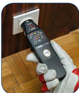
L'adaptateur C.A 751 permet un contrôle visuel du bon raccordement de toute prise de courant 2P+T. Associé au DDT, il permet le repérage de phase et la détection de tension.
