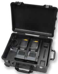
**Kit portable :** station de test IntelliDoX entièrement portable dans un étui Pelican. Le kit contient : 2 modules d'accueil, un câble Ethernet, un adaptateur d'alimentation CA, un régulateur de débit à la demande, une gaine et bien plus encore.
