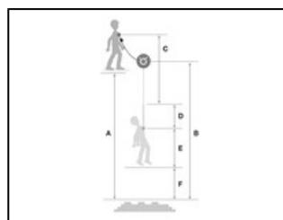
Afin d'aider à sécuriser les interventions, Petzl propose un module de calcul du tirant d'air, simple et rapide, obtenu grâce au poids de l'utilisateur et à la longueur de sa longe.
