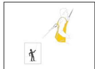
Possibilité de connecter une corde de guidage à l'arrière pour orienter la victime lors de l'arrivée au sol.
