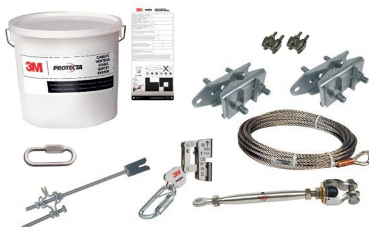
Le kit comprend tous les composants nécessaires : coulisseau (6180200), ancrages universels supérieur et inférieur (AC340 x 2), tendeur de câble (AC330), connecteur de liaison à vis ovale (AJ502), câble en acier inoxydable (AC300SXX), quantité de guide de câble comme indiqué dans le tableau (AC320), étiquette système (6191088) et 2 serre-câbles de 8 mm (M540008080).
