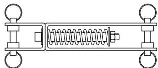
**F – Anticaídas stopcable™ equipado con un conector M10 y un absorbedor de energía**
