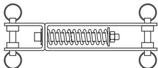
**F – Anticaduta stopcable™ dotato di un connettore M10 e di un assorbitore di energia**
