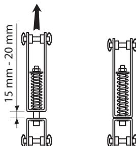
OBSERVACIÓN: El ajuste comprendido entre 15 y 20 mm corresponde a una carga máxima de puesta en tensión de la línea de vida de 50 daN.
