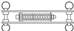
**F – Urządzenie zapobiegające upadkom stopcable™ wyposażone w łącznik M10 i absorber energii**
