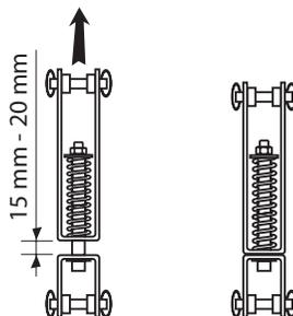
ANMÄRKNING : Regleringen mellan 15 och 20 mm motsvarar en maximal belastning med spänd livlina på 50 daN.
