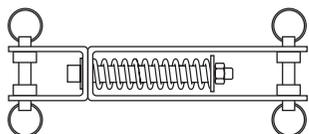
F – stopcable™ faldsikring med M10 koblingselement og energiabsorber
