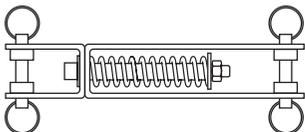
**F – Antiqueda stopcable™ equipado com um conector M10 e um absorvedor de energia**
