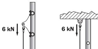
Voor alle andere configuraties moet het anker een minimum van 6kN in de richting van de kabel weerstaan. Neem indien nodig contact op met Tractel SAS.
