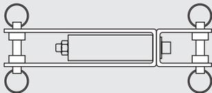
**D – Napinacz z wskaźnikiem napięcia wstępnego**
