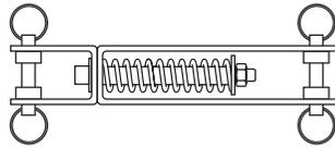
**F – Страховочная каретка stopcable™, оснащённое оснащённая карабином M10 и амортизатором**
