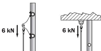
För alla andra konfigurationer ska förankringen stödja en kraft på minst 6 kN i vajerns riktning. Kontakta Tractel SAS vid behov.
