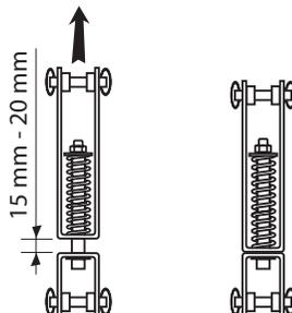
OPMERKING: Een afstelling tussen 15 en 20 mm komt overeen met een maximale belasting van 50 daN.
