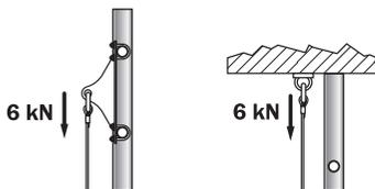
Para quaisquer outras configurações, a amarração do suporte deverá suportar um esforço de 6kN no mínimo na direção do cabo. Em caso de necessidade, contatar a Tractel SAS.
