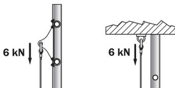
Per qualsiasi altra configurazione, l'ancoraggio dovrà sopportare un sforzo di 6kN mini nella direzione della fune. In caso di necessità contattare Tractel SAS.
