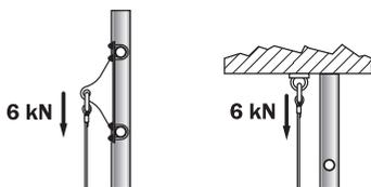
Pour toutes autres configurations, l'ancrage devra supporter un effort de 6kN mini dans la direction du câble. En cas de besoin contacter Tractel SAS.
