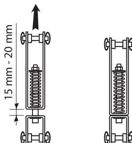
ПРИМЕЧАНИЕ: регулировка в диапазоне от 15 до 20 мм соответствует максимальной силе натяжения анкерной линии в 50 даН.
