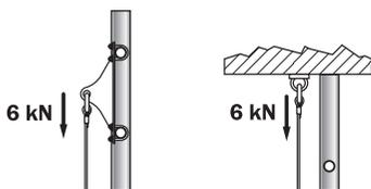
For alle andre konfigurasjoner må forankringen tåle en belastning på minst 6 kN i kabelretningen. Kontakt Tractel SAS ved behov.
