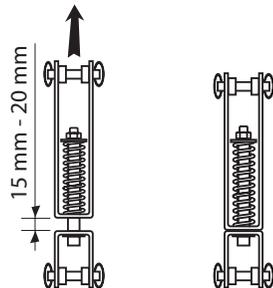
ANMERKUNG: Die Einstellung zwischen 15 und 20 mm entspricht einer maximalen Vorspannung der Steigschutzeinrichtung von 50 daN.
