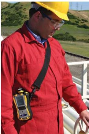
*MultiRAE utilisé pour la surveillance de l'exposition des travailleurs dans une raffinerie*
