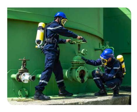
L'Aeris Confort Type 2 est composé d'un détendeur compensé haute/moyenne pression (HP/MP), d'un harnais confortable avec sangles en aramide, d'un masque complet, d'une soupape à la demande à pression positive et d'une alarme sonore intégrée dans la poignée du manomètre haute pression.
