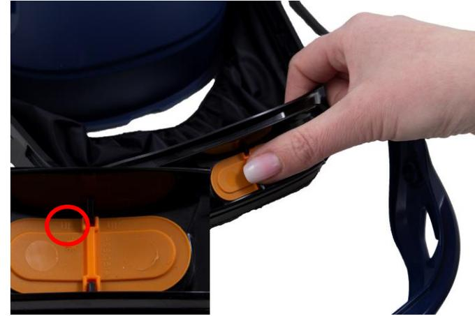
**6.3** Appuyer sur la nouvelle membrane pour la positionner correctement, comme illustré. La mention « UP » (haut) sur la membrane doit être visible si elle est montée comme indiqué. Vérifier soigneusement que la membrane est complètement en contact avec le siège de la valve.
