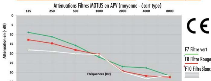
Atténuation des filtres mesurée par TNO\* selon la norme EN 352-2 & ISO 4869 - 2a. CEcertificat n°C36-169
