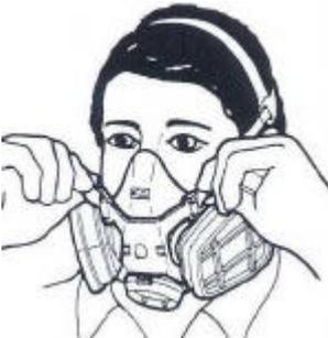
3. Serrer les brides supérieures en tirant sur les extrémités jusqu'à obtention de l'étanchéité. (La tension des brides peut être réduite en appuyant sur le dos des boucles).
