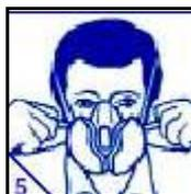
4. Serrer d'abord la lanière supérieure en tirant sur les extrémités de manière à obtenir une étanchéité confortable. Serrer ensuite les lanières inférieures de façon similaire. (La tension des lanières peut être réduite en poussant sur la partie plate des boucles de serrage.)
