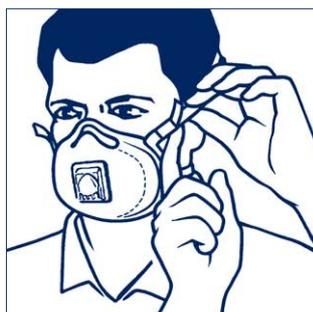
5. La tension des brides peut être diminuée sans retirer le masque, en poussant simplement sur la partie plate des boucles de serrage. Si un bon ajustement ne peut être obtenu, ne pas pénétrer dans la zone contaminée.
