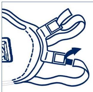
1. Enfiler la bride élastique supérieure dans la boucle de serrage correspondante. Répéter la même opération pour la bride inférieure. Placer le masque sous le menton, la barrette nasale en haut. Placer la bride élastique inférieure autour de la tête, juste en dessous des oreilles.
