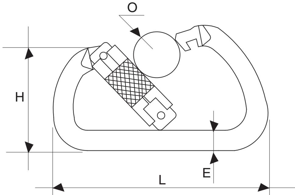
**Mousqueton acier à verrouillage automatique par bague tournante.**
