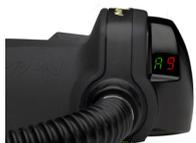
Lorsque l'affichage numérique indique A9, la batterie est complètement chargée et peut fournir la puissance maximale. Lorsque A0 clignote sur l'affichage, la capacité de la batterie a chuté au-dessous du niveau requis pour maintenir le débit. Une alarme sonore de batterie faible retentit lorsque A0 s'affiche, il reste environ 10-15 minutes avant que le débit de 160 l/min chute.
