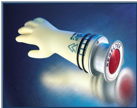
Avant chaque utilisation des gants isolants pour travaux sous tension, la norme EN 60903:2003 recommande une vérification de leur état par une inspection visuelle. Cette inspection consiste en un gonflage à l'air pour vérifier d'éventuelles fuites d'air.
