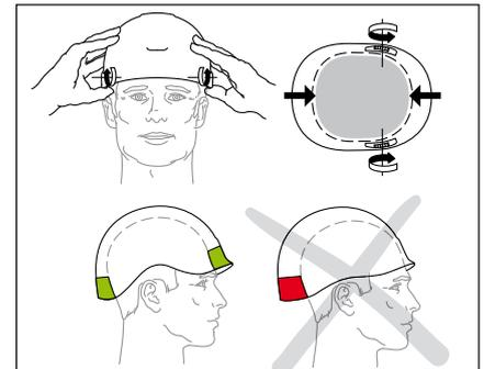
Système de réglage CenterFit : L'action conjointe des deux molettes de réglage ajuste le tour de tête, tout en conservant le centrage de la tête. Molettes de réglage manipulables avec des gants
