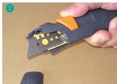
3 Placer une nouvelle lame. Relâcher la lame, puis le curseur. Remettre la trappe.
