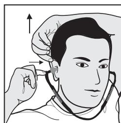
2. S'assurez que l'extrémité du bouchon est positionnée dans l'axe du conduit auditif. Saisissez le haut de l'oreille, tirez vers le haut et poussez l'embout dans l'oreille.
