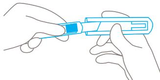
Lors de l'insertion, ne pas placer la main dans la zone de sortie de la lame !
