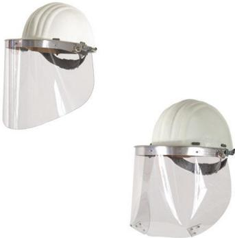
réalisée en polycarbonate incolore - épaisseur 1mm - traitement anti-rayures adaptable sur casque par l'arceau de relevage réf 9100 ou sur le serre-tête 9120 - Existe en version standard (402) ou avec retour menton (405) - certains modèles comportent des boutons pression pour adaptation sur cagoules spéciales - Indices normes EN 166 : 1 = port occasionnel ou permanent , B = impacts de moyenne énergie, 9 = résistance au métal fondu et solides chauds
