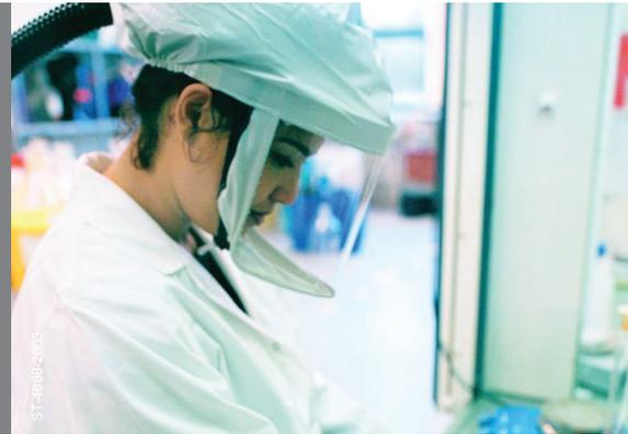
Le système Dräger X-plore® 9000 est raccordé via un tuyau de 10 mètres de long ou via un tuyau spiralé directement à un réseau d'air comprimé, à une source d'alimentation mobile ou à un compresseur. Une vanne de régulation silencieuse et pouvant être ajustée au préalable, diffuse un débit d'air constant de 160 litres par minute dans le circuit de la tête et procure sans restriction dans le temps une
