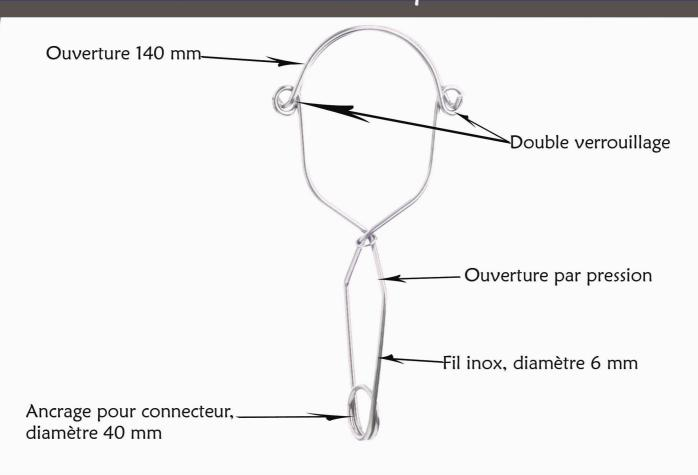
**Produit et utilisation :** Connecteur inox pour équipement de protection antichute. Permet de s'amarrer sur une structure telle que les échafaudages, les pylônes ou les charpentes métalliques.
