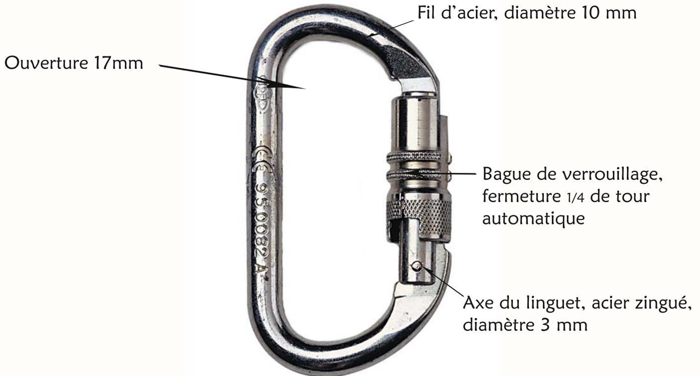
**Produit et utilisation :** Connecteur pour un équipement de protection antichute. Très robuste de part sa fabrication en acier.
