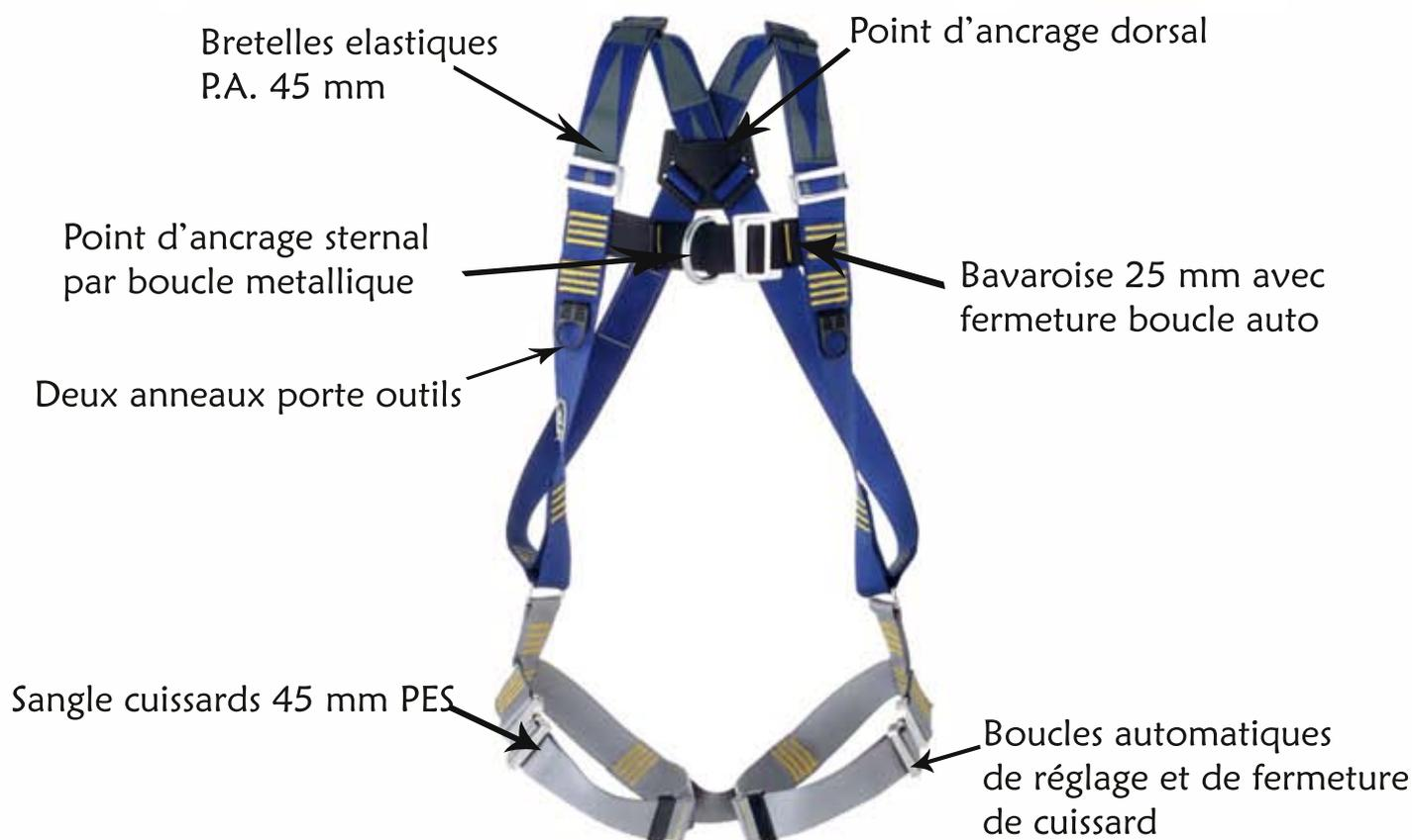
**Produit et utilisation :** Harnais muni d'un point d'ancrage dorsal et d'un point d'ancrage sternal (formé par une boucle métallique). Utilisation : divers travaux hauteur, fermeture des cuissards en automatique.
