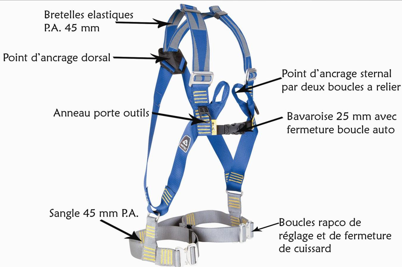
**Produit et utilisation :** Harnais muni d'un point d'ancrage dorsal et d'un point d'ancrage sternal (formé par deux boucles à relier). Utilisation : divers travaux hauteur, fermeture des cuissards en boucles rapco, cuissard horizontal évitant toute prise à l'aine.
