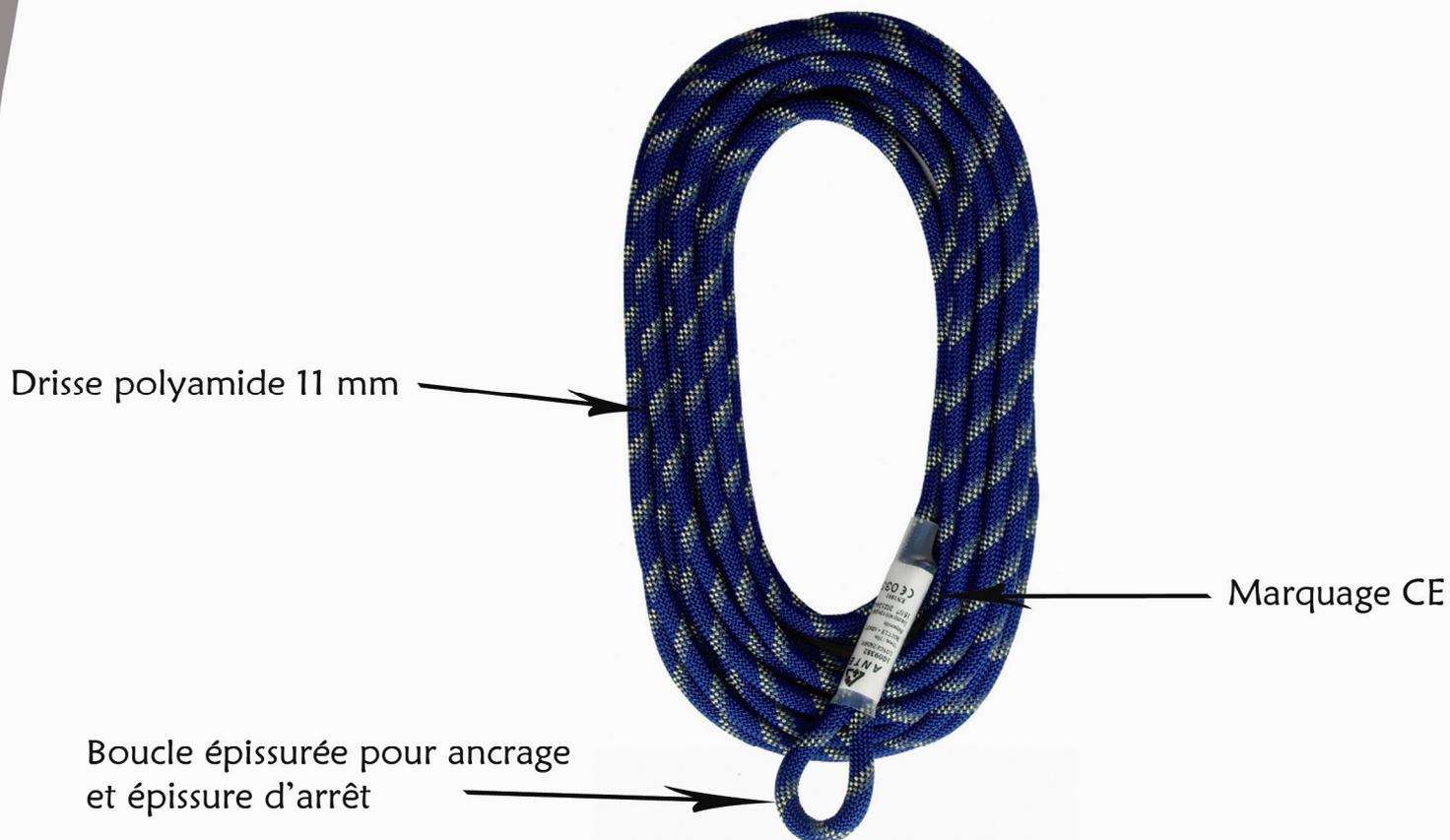
**Produit et utilisation :** Drisse polyamide conforme EN 1891 pour coulisseau BLOCMAX. Composée de 8 âmes câblées, gaine de 32 fuseaux, bloduc identifiant le fabricant et la date de fabrication
