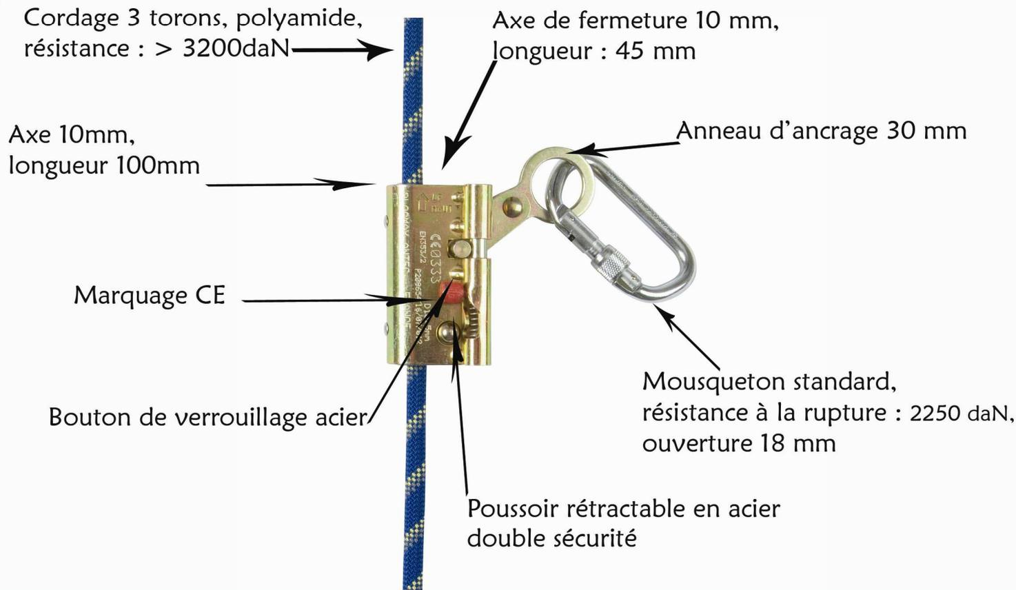
**Produit et utilisation :** Antichute coulisseau acier zingué bichromaté. Connecter le coulisseau sur un point d'accrochage dorsal ou sternal conforme EN 361. Il est interdit de prolonger la liaison entre le coulisseau et le harnais
