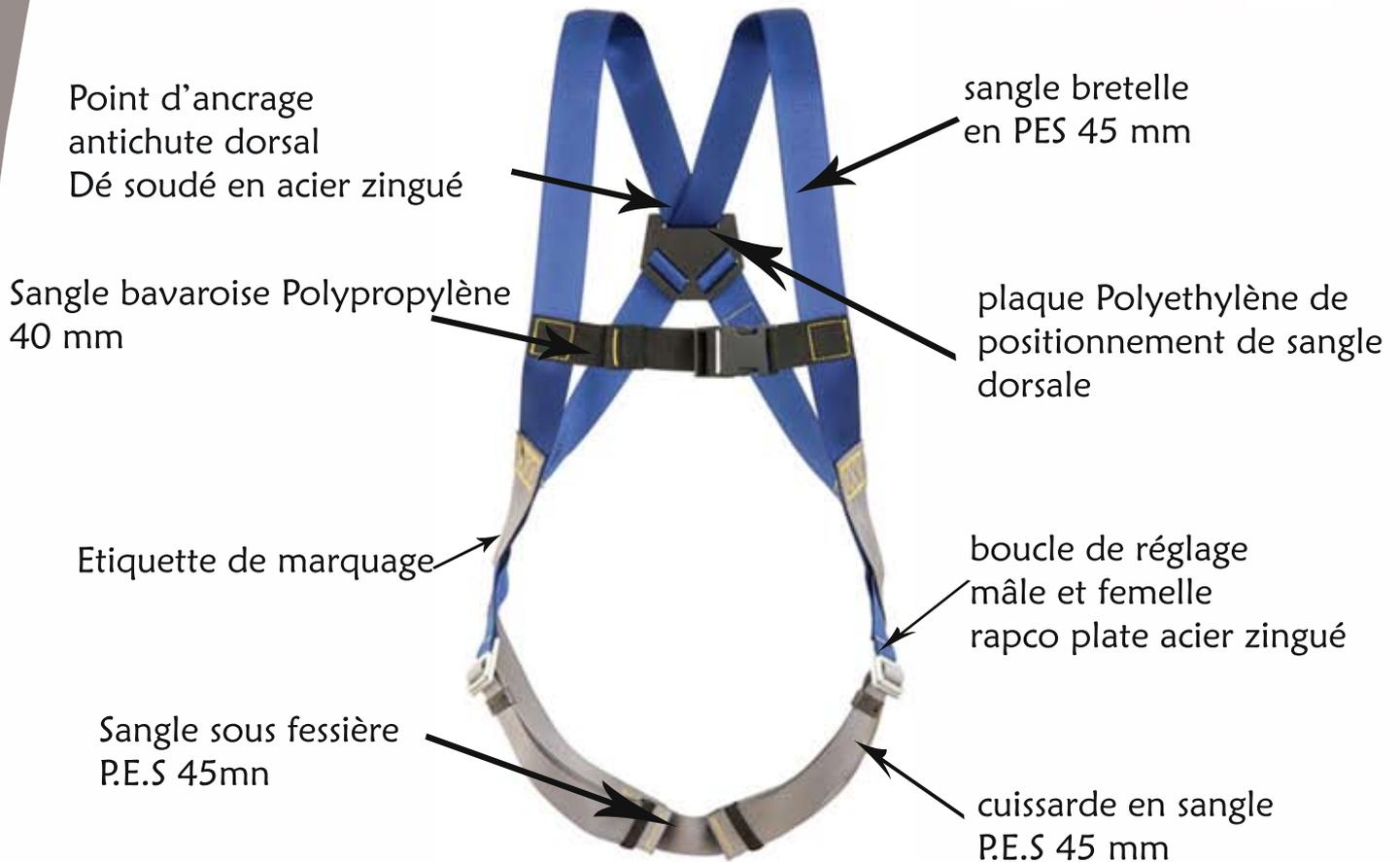
**Produit et utilisation :** Harnais de sécurité antichute muni d'un point d'ancrage dorsal. Secteurs industriels divers. Ce harnais doit être utilisé connecté à un système antichute conforme EN 353-1, EN 353-2, EN 355, EN 360 et par un mousqueton conforme EN 362.
