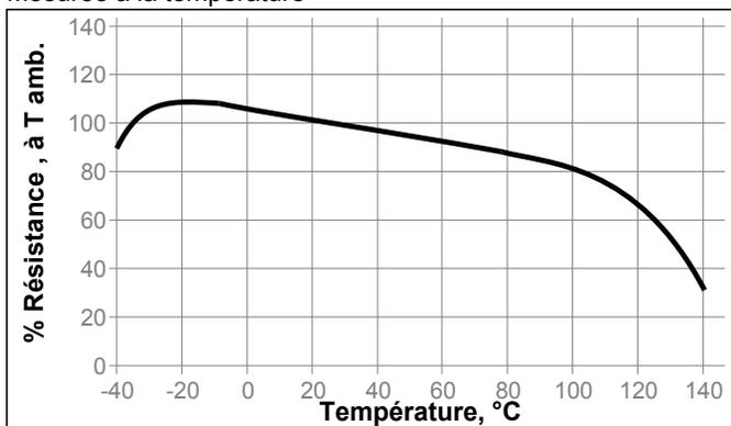
**Résistance au vieillissement à chaud : Vieillessement à la température indiquée et mesure après retour à 22 °C**
