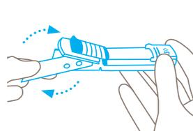
Retirez et retournez (pour gauchers) ou changez la lame. Veillez à bien réinstaller la lame en la plaçant **exactement sur l'ergot**.
