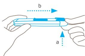
Appuyez sur le bouton de changement de lame et tirez l'insert en plastique vers l'arrière pour le sortir du manche.
