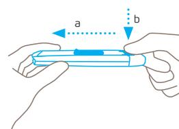
Refermez la protection de la lame et repoussez l'insert en plastique dans le manche jusqu'à ce que le bouton de changement de lame **reprenne sa position initiale**.
