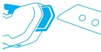
**Retournez ou remplacez** la lame. Veillez à ce que la lame repose de nouveau exactement sur les ergots du support de lame.
