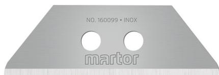
La LAME TRAPÉZOÏDALE N° 160099 de MARTOR est une lame de qualité supérieure en acier inoxydable. Elle est extrêmement coupante et possède deux côtés tranchants utilisables consécutivement pour une durée de vie prolongée. La lame mesure 55,5 mm de long, 19,0 mm de large et 0,63 mm d'épaisseur. L'affûtage large facilite la coupe, les pointes arrondies augmentent votre sécurité. L'huile utilisée pour la lame est de qualité alimentaire.
