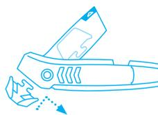
Positionnez la lame de rechange **parallèlement** à la partie inférieure du manche et insérez-la. Coulissez ensuite la tête de lame **vers la droite** jusqu'à la butée.
