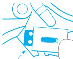
Calez ensuite la lame **sur le bord** gauche et remplacez-la **exactement** sur l'ergot.
