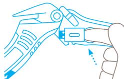
Relevez le cache-lame en mettant le pouce sur le symbole de la lame et extrayez celle-ci par le **côté**. Retournez ou remplacez la lame.
